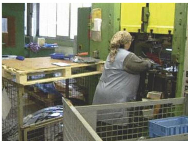
**Figure 2 - Poste de travail avec presse à évaluer, Source : BIT**
